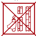
слабая тяга (Не используйте котел!)
